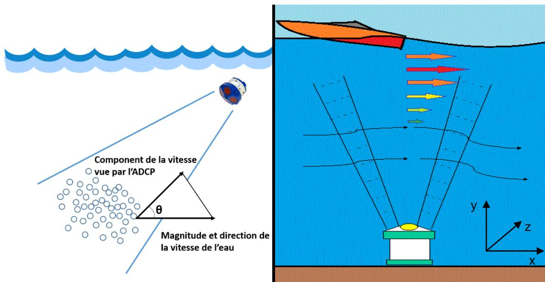
Figure 5: Mesures de courant en 3 dimensions (RD Instrument, 1989)
