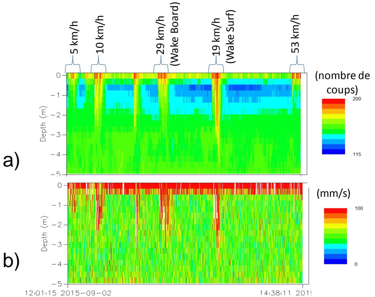
Figure 7: Intensité moyenne (a) et vitesse générées (b) lors du passage des « Wake Boat » à différentes vitesses pour le 1<sup>er</sup> jour d'essai
