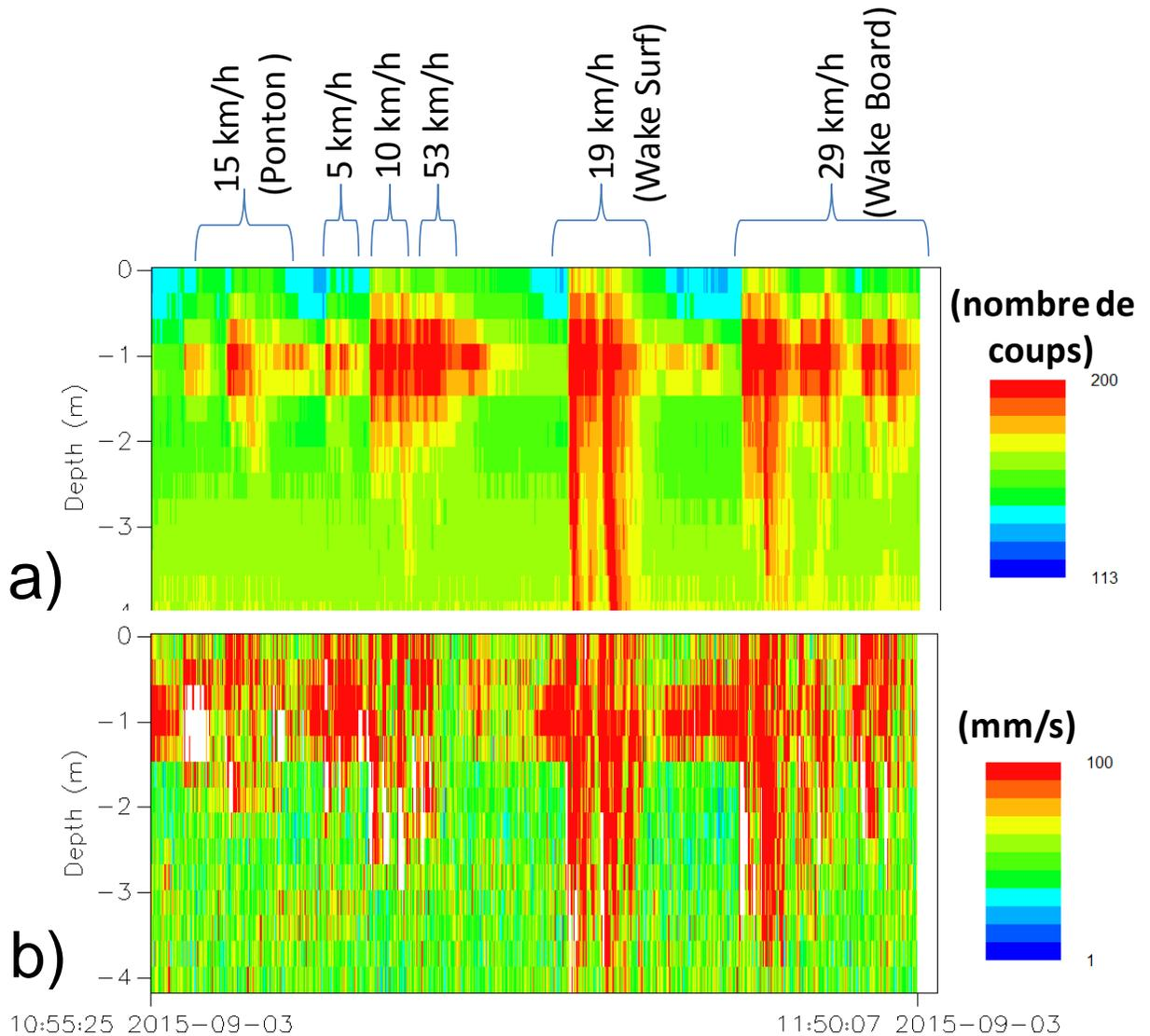
Figure 8: Intensité moyenne (a) et vitesse générées (b) lors du passage des « Wake Boat » à différentes vitesses pour le 2<sup>ème</sup> jour d'essai
