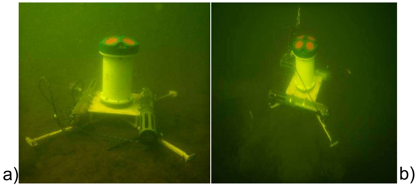
Figure 11 : Vue du dispositif expérimental avant (a) et 2 minutes après (b) le passage d'un « Wake Boat »
